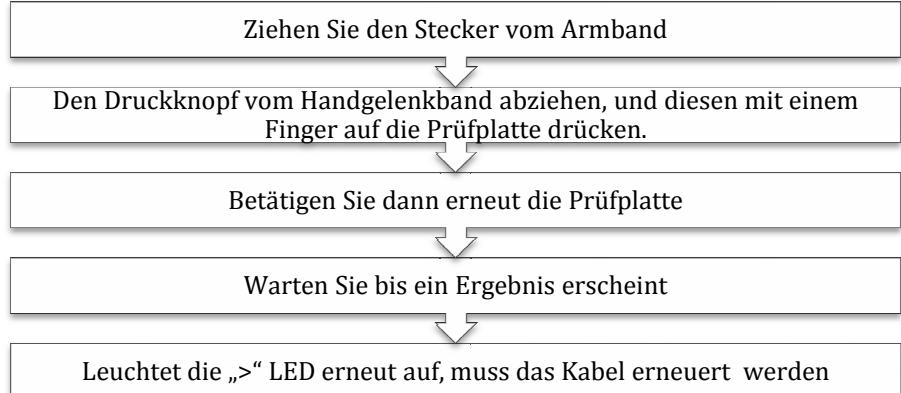
Ist das Kabel in Ordnung, leuchtet keine der Wrist strap LED's auf. In diesem Fall ist der Kontaktwiderstand zwischen Armband und Handgelenk zu hoch.
