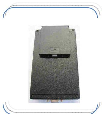
Das Gerät besitzt eine Batterieüberwachung. Liegt die Batteriespannung unterhalb des Grenzwertes, ertönt ein akustisches Signal mit ca. 1Hz. In diesem Falle müssen die Batterien ausgewechselt bzw. die Akkus aufgeladen werden.
