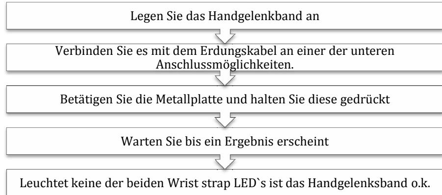
Leuchtet die „<“ LED auf, ist der Strombegrenzungswiderstand im Erdungskabel defekt. Tauschen Sie in diesem Falle das Erdungskabel aus.
